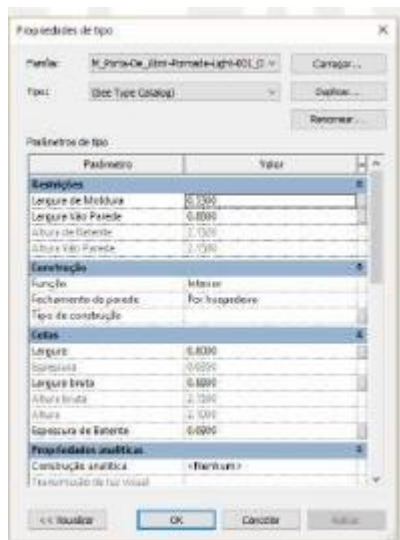
Figura 73 - Janela para alterar dimensões das portas
