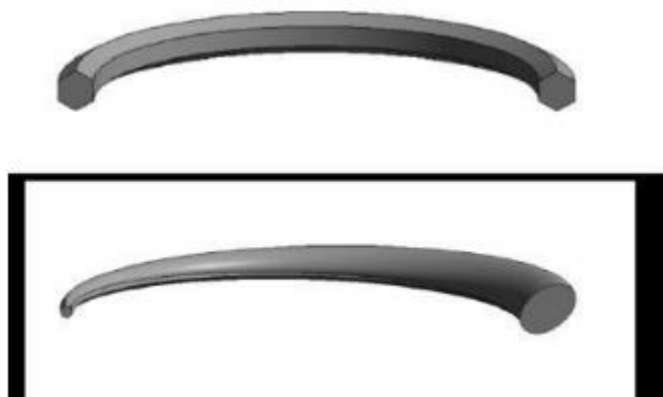
Figura 140 - Exemplo de Varredura Simples (acima) e Varredura com Mescla (abaixo)
