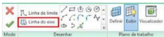
Figura 139 - Caminho para desenhar a linha de eixo de revolução do objeto
