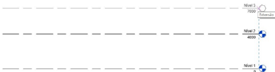
Figura 17 – Alinhamento e finalização do novo nível
