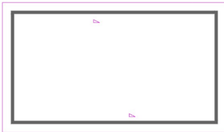
Figura 78 - Croqui do telhado com inclinação nas águas de cima e de baixo
