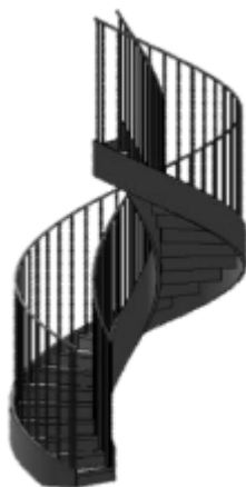
Figura 102 - Escada em espiral
