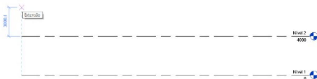
Figura 16 – Definição da cota do novo nível
